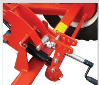
**Impianto di frenatura a comando idraulico**
