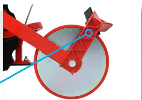
**Supporto del raschiaterra in fusione d'acciaio**
